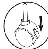
Для перемещения кровати фиксатор колесной опоры должен быть установлен в верхнем положении. Для эксплуатации кровати фиксатор колесных опор установите в нижнее положение, как показано на рисунке.
