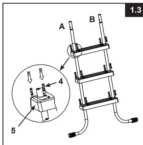
Вставьте крепежные штифты (4) в отверстия, фиксирующие лестницу в ровной позиции на опорных стойках.
