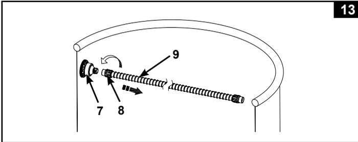
3. Открутите адаптер шланга (7) против часовой стрелки от резьбового разъема фильтра. Извлеките микросито (6) из адаптера шланга. С помощью садового шланга очистите и удалите мусор с микросита и адаптера шланга. См. рис. 14.
