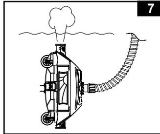
8. Включите фильтрационный насос и убедитесь, что вода течет через микросито (6) и адаптер шланга (7). Теперь Водяной пылесос подключен и может начать уборку дна бассейна. См. рис. 8.
